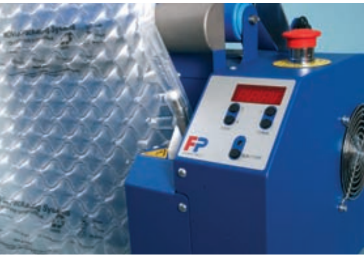
Wyświetlacz służy do nastawienia długości poduszek powietrznych w metrach.
